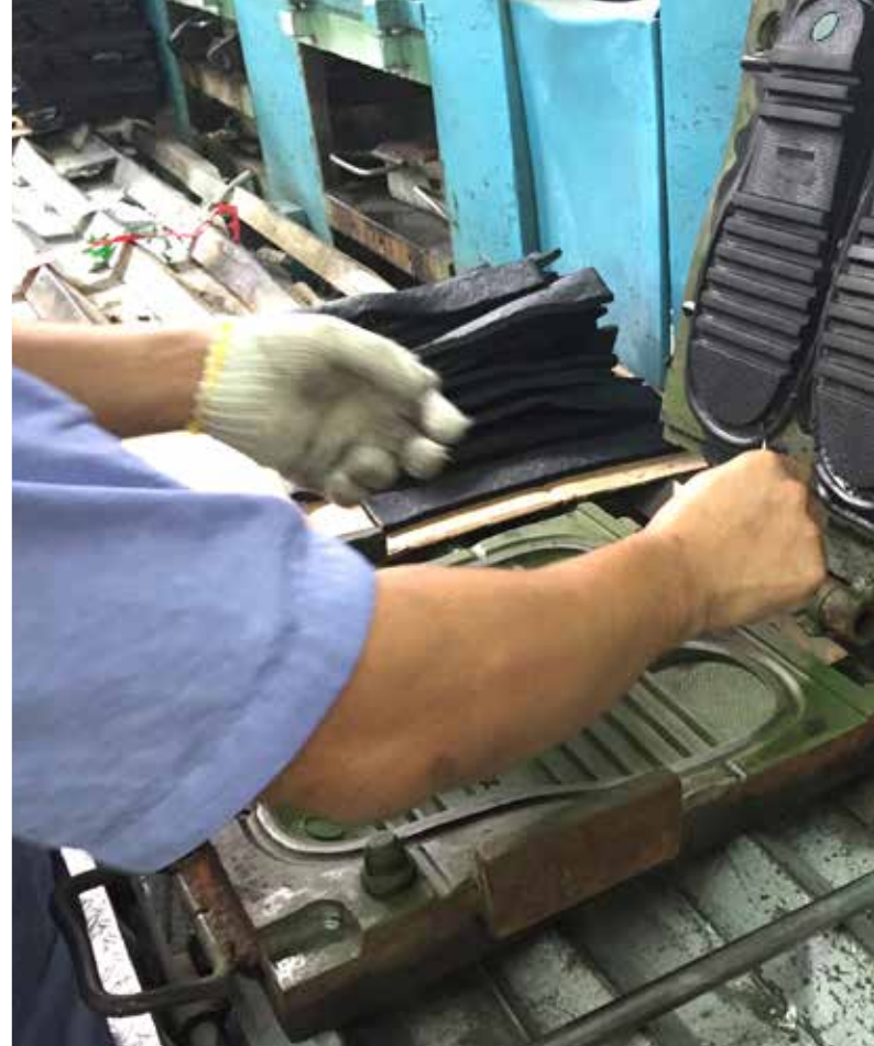
模具打开，橡胶冷却。是时候把橡皮从模具里剥下来了。
