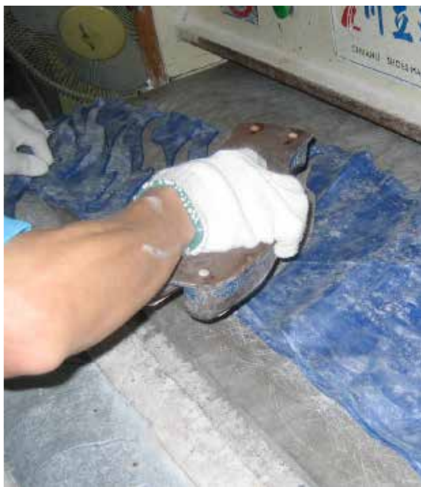
未硫化的橡胶非常粘, 所以这里已经在表面覆上粉状物, 便于切割。
