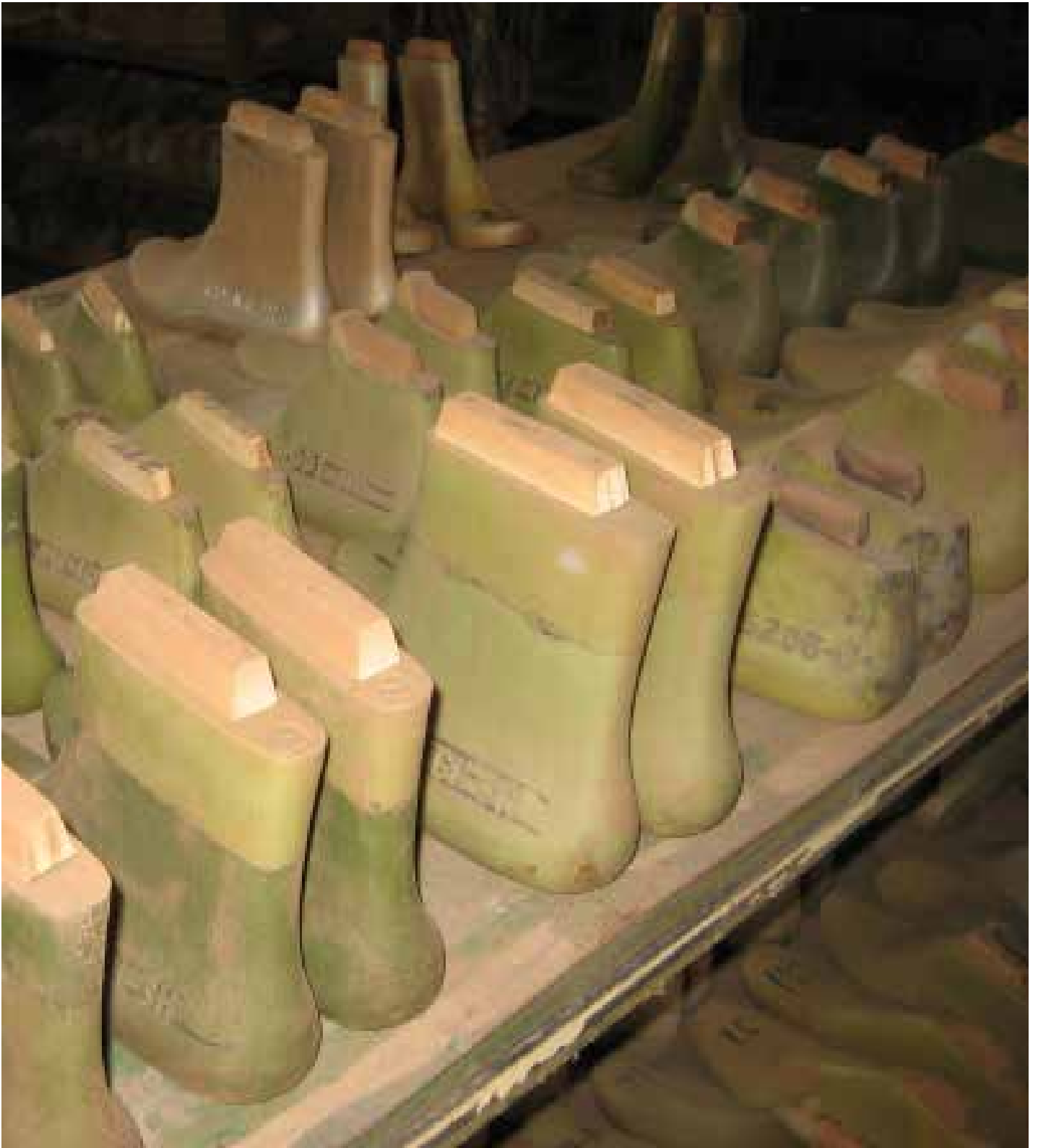
这些是塑料制成的鞋楦，用作制作金属铸造鞋楦的基础。
