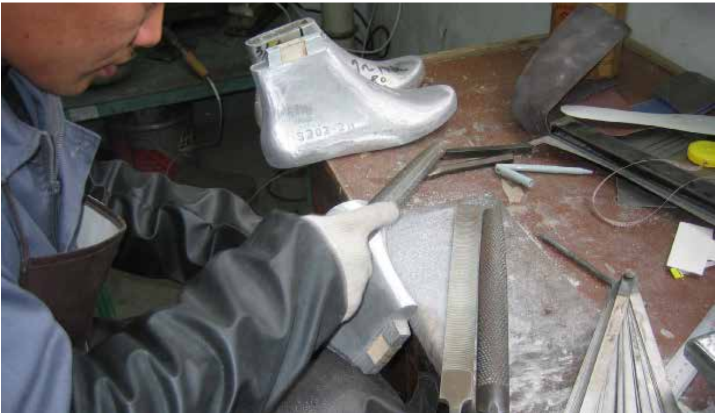
鞋楦现在已经准备好了。金属闪光和瑕疵掉了下来。鞋楦必须光滑，所以在成型过程中没有粗糙的边缘损坏鞋子。你可以看到它的码数和代码号。
