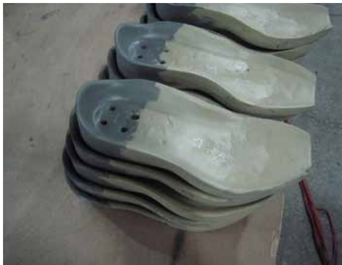
这些是为最终成型操作准备好的膨胀预成型件。
