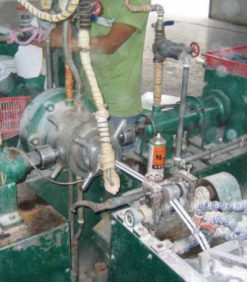
这是一种双色挤压机。 白色和黑色的橡胶被放入磨机粉碎并混合。
