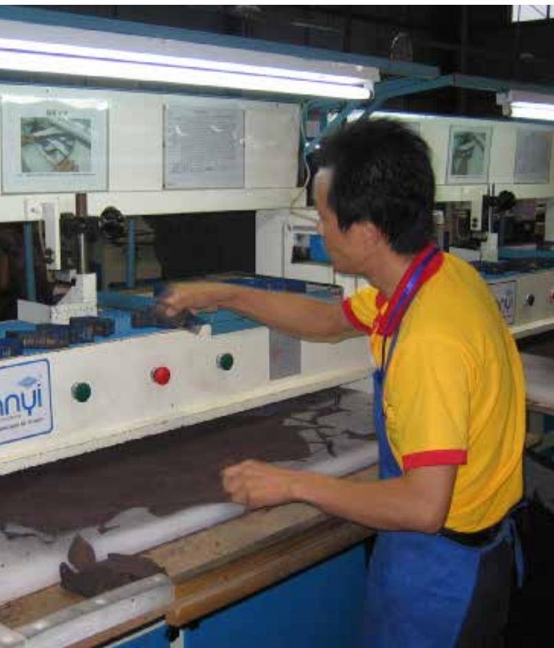
这是一个在裁切室的液压安全压力机。两个绿色按钮必须被按下。
