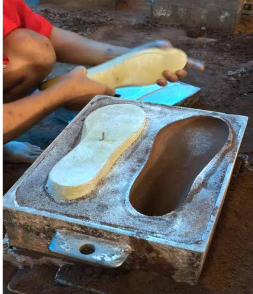
模具现在已准备好置入砂芯模。这将型成中空的成品鞋楦。
