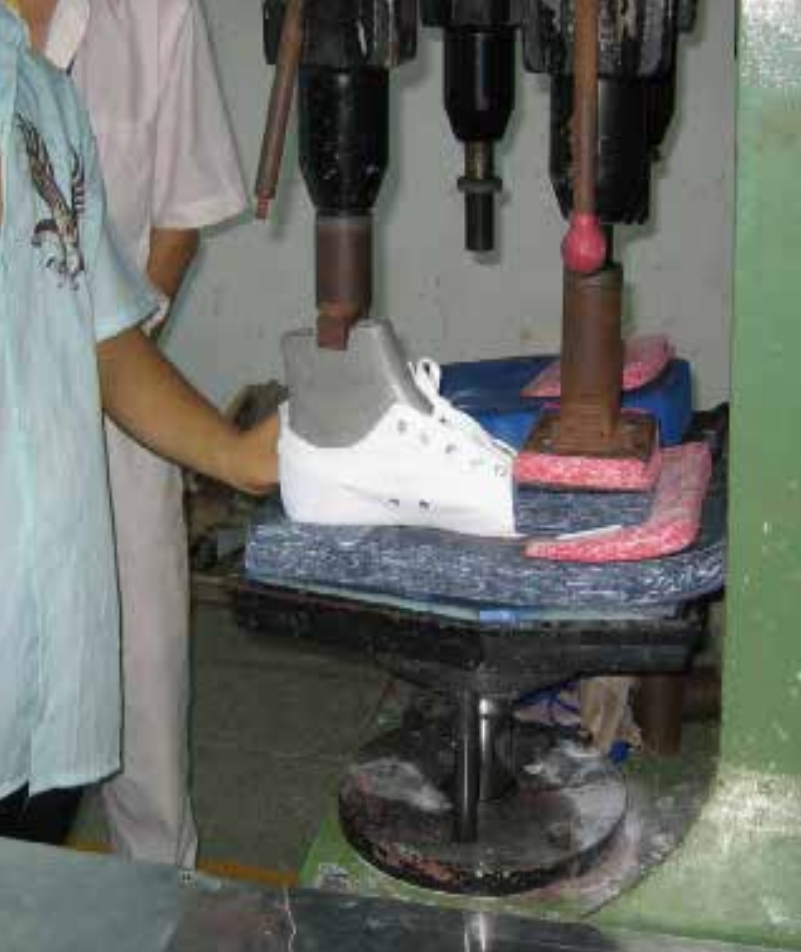
在操作沿条之前，鞋头片和鞋底底部用机器压紧。
