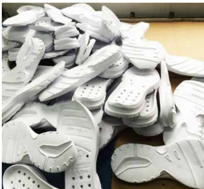
热压部件具有坚固的表皮、较高的密度和新图案细节。几乎所有的跑鞋都是这样制成的。
