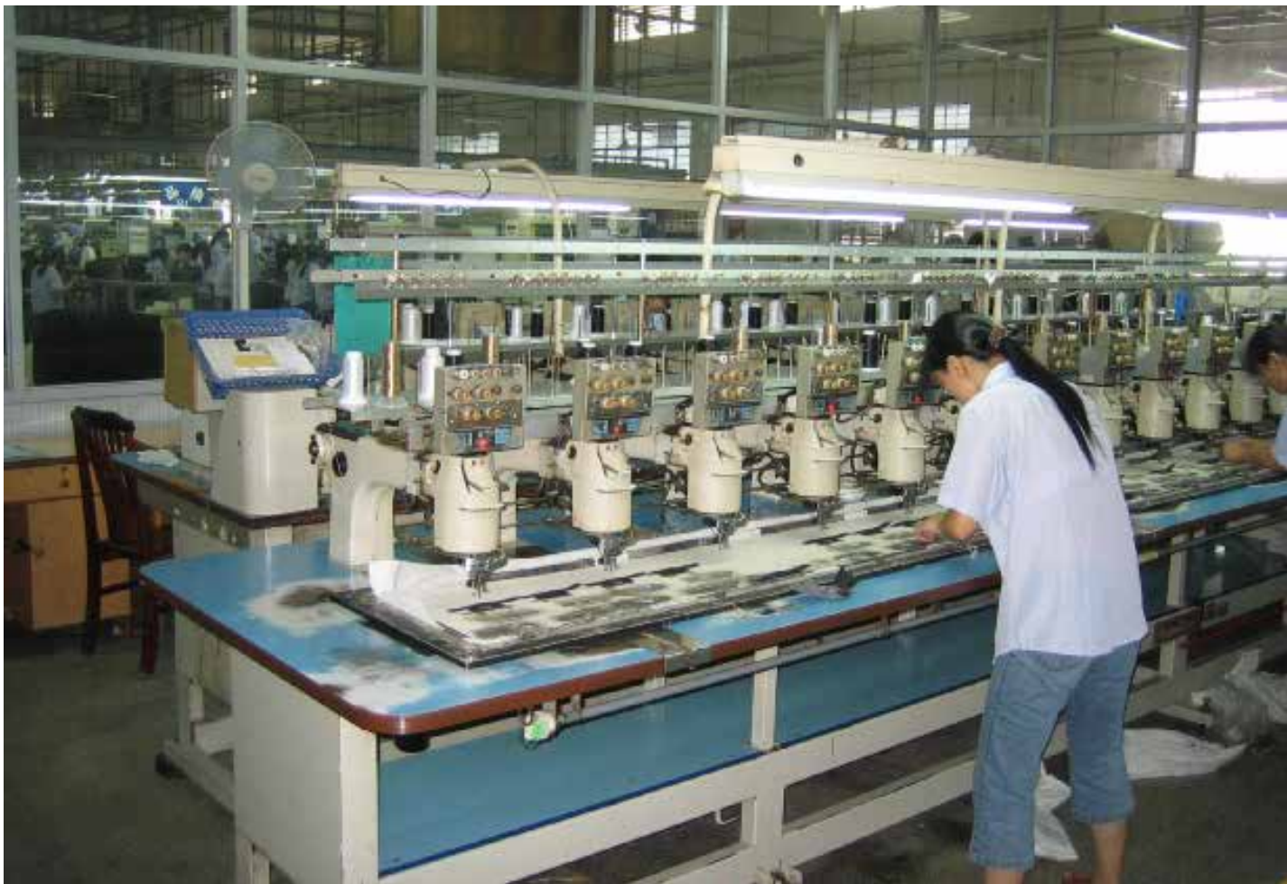
这其实是一台电绣机！20个缝纫针头一起移动。这台复杂的机器被保存在独自的房间里，以防灰尘和堵塞噪音。
