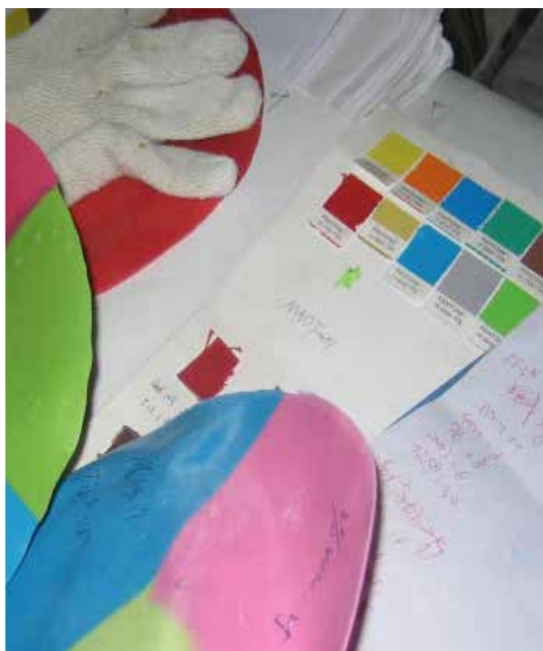
一个工人正在用潘通色卡号比对，检查固化橡胶以此来确认橡胶样品。
