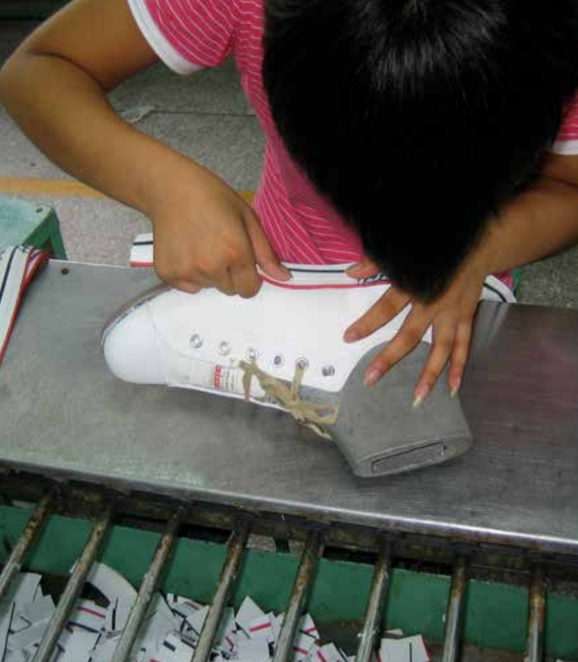
工人小心而仔细地将沿条商标与鞋面的印刷商标对齐。
