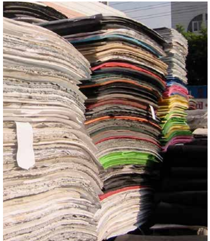
在膨胀压榨机之外，原料EVA合成物现在是一大块泡棉。
