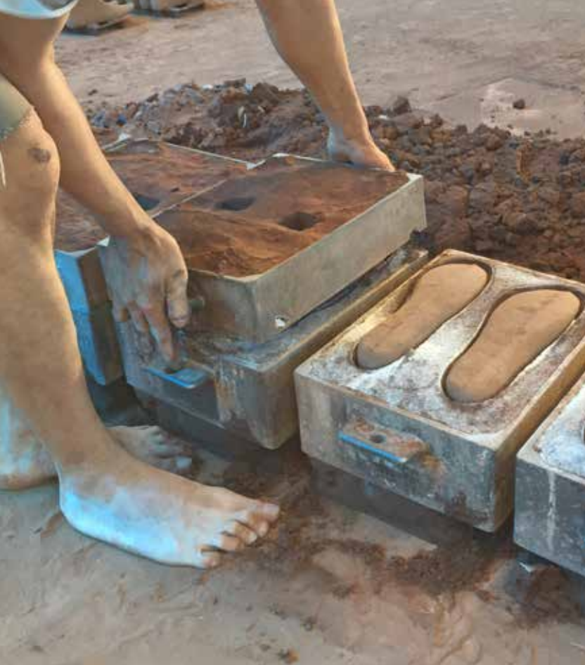
这是装配好的模具。顶部的孔是浇注液态铝金属的地方。
