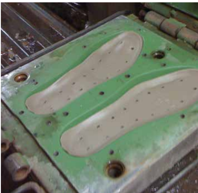
预制件被压入最终模具。该模具非常热，将导致泡棉表皮重新熔化，并将重新激活发泡剂（再次发泡）。这叫热压EVA。
