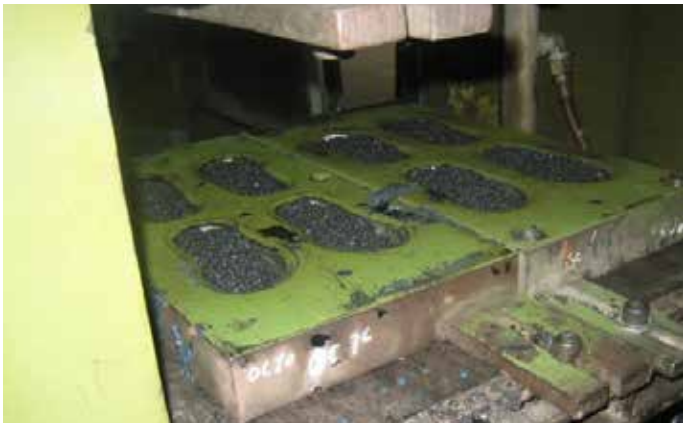
将原料颗粒放入膨胀模具中，制备用于热EVA压模。就在几年前，工厂使用模切板手工制作。
