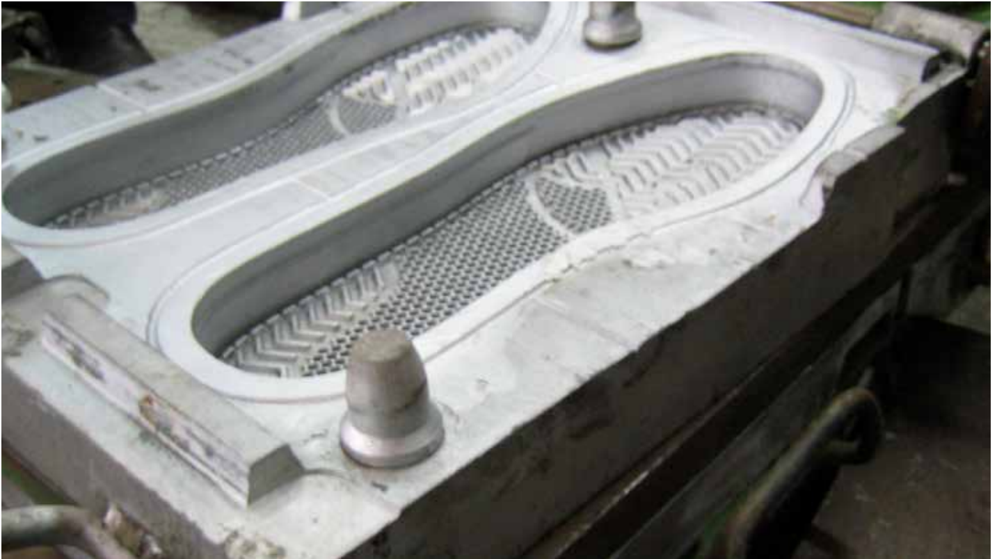
这种模具是由金属铸造或CNC数控机床製造完成。大底模具通常是钢制的。EVA中底模具可由铸铝制成。
