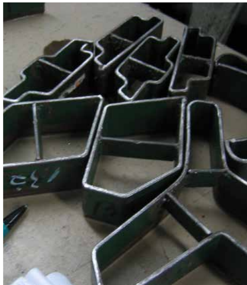
裁切模具被组合在一起以进行有效的切割。一个鞋子的部件可以由几个工人裁剪。
