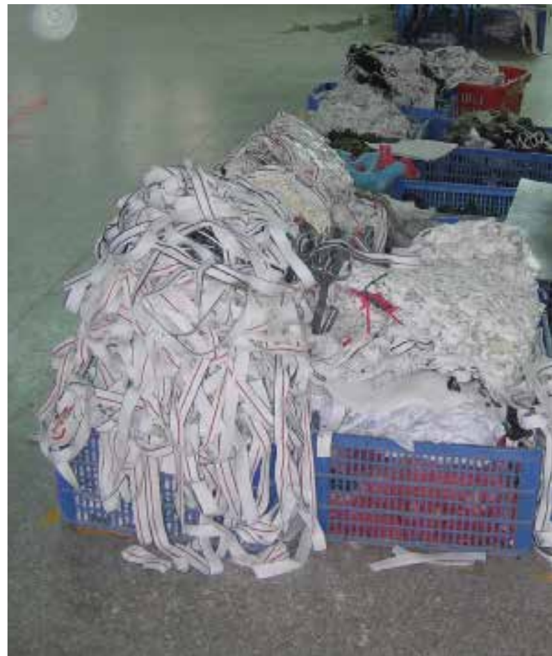
旧条带不能使用，几天后它将失去其粘性和融性。 这堆条带将被重新粉碎并用于制造粘合填料或减震填料。
