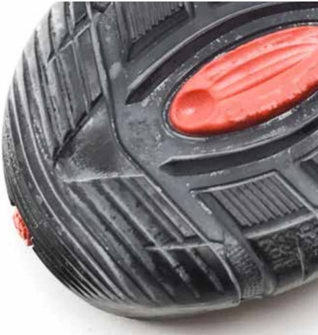
橡胶吐霜-橡胶内部的化学物质被溶出。
