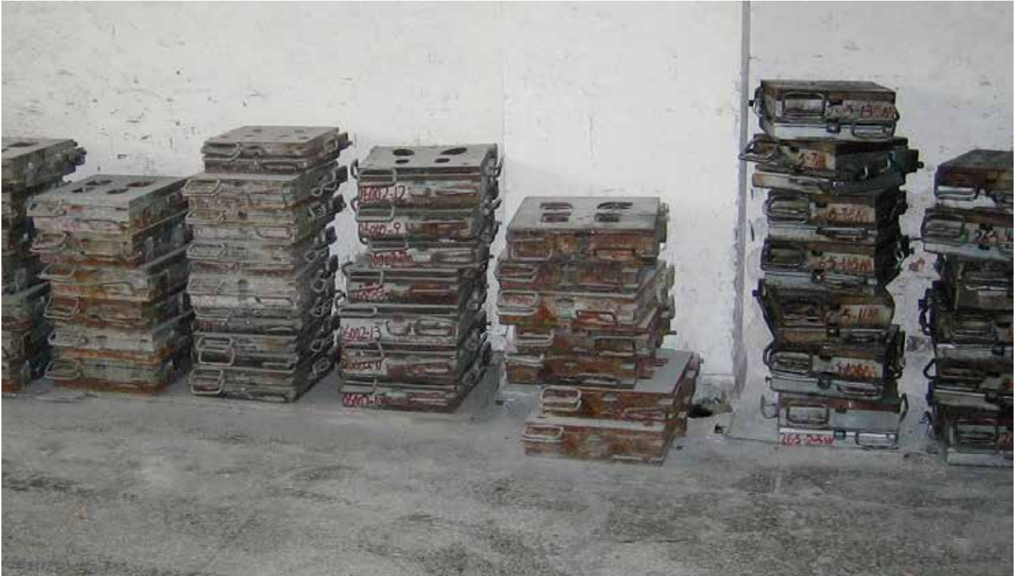
它需要许多模具来生产鞋底。这里，这些模具在压底厂等待。虽然鞋品牌或鞋廠可能拥有模具，他们往往被放在橡胶压模厂。如果模具需要修理或调整，它将被送回模具车间。如果你想要模具被送回来，你需要确保橡胶压模底已按时付清！
