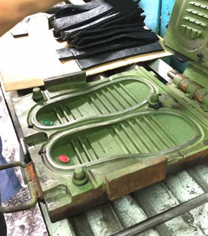
模具在开启状态中，后跟商标现在在在模具中。 在这里你可以看到顶部模具的块状。
