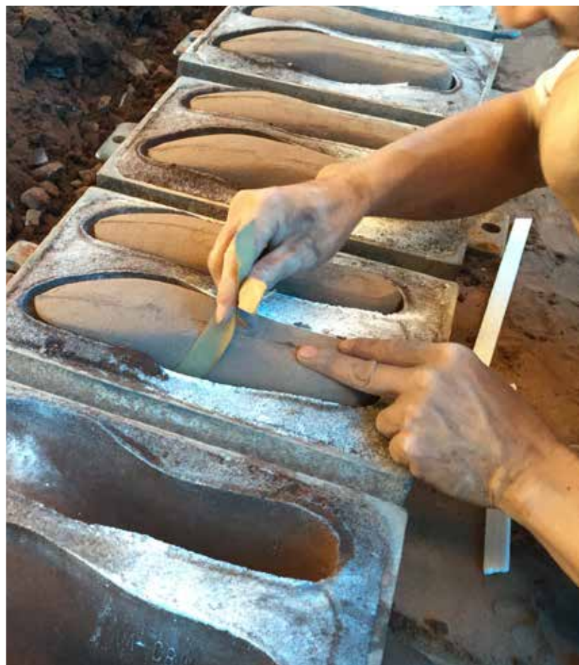
工人通过一根线或塑料将砂芯模降低到模具中。
