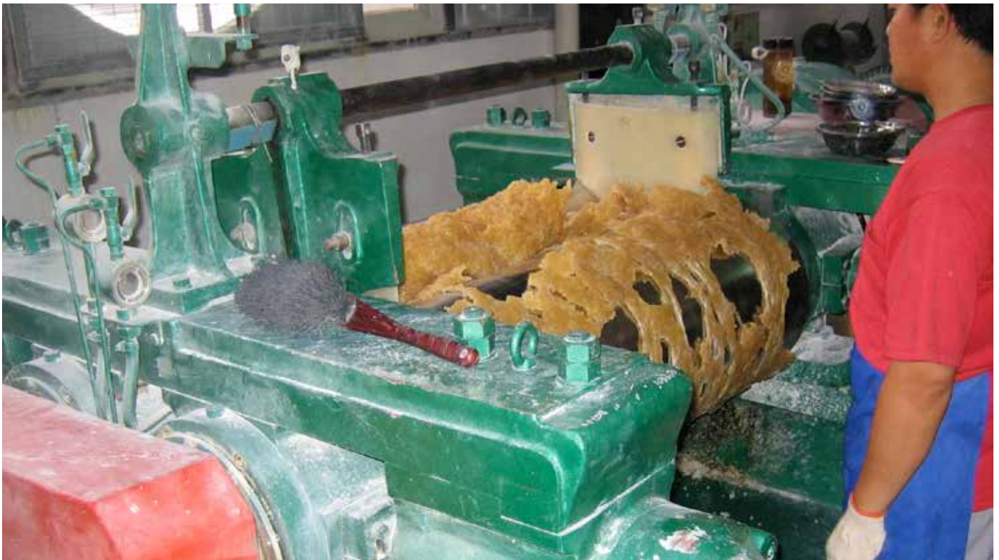
与干燥合成剂混合在一起之后，它们被移动到轧钢机。
