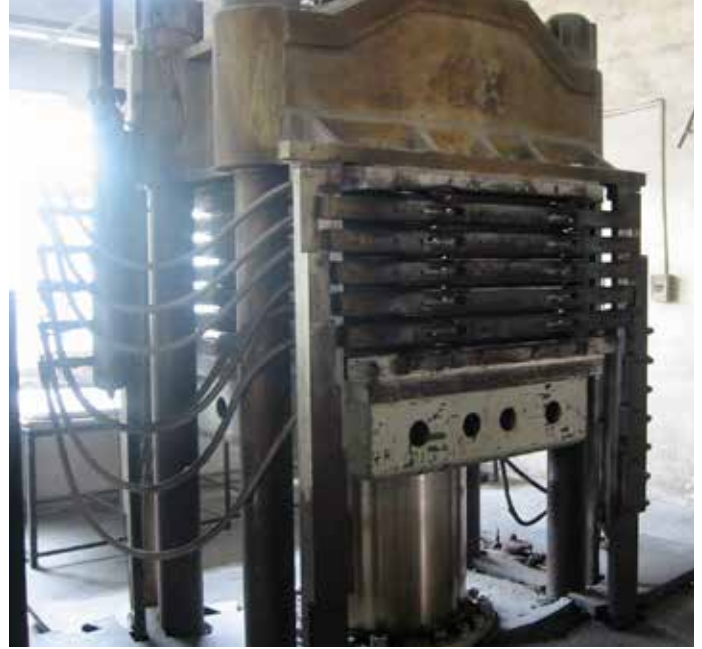
随着膨胀机关闭，热量和压力开始上升。流向压制机的管道充满了热油。在压制机内，原料EVA进入临界状态，发泡剂产生微小气泡，形成泡沫。
