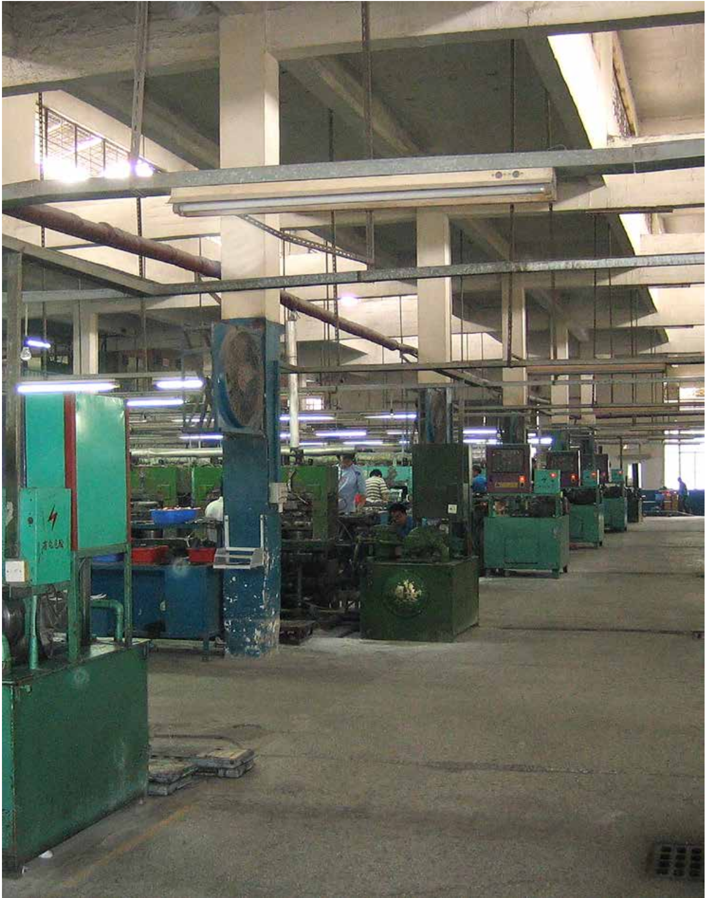
一个很大的橡胶压制室，有许多压制机。天花板很高以便让热压散去。每个操作员同时处理几个压制开口。未硫化的橡胶堆放在顶部，压制过的部件则放在底部。
