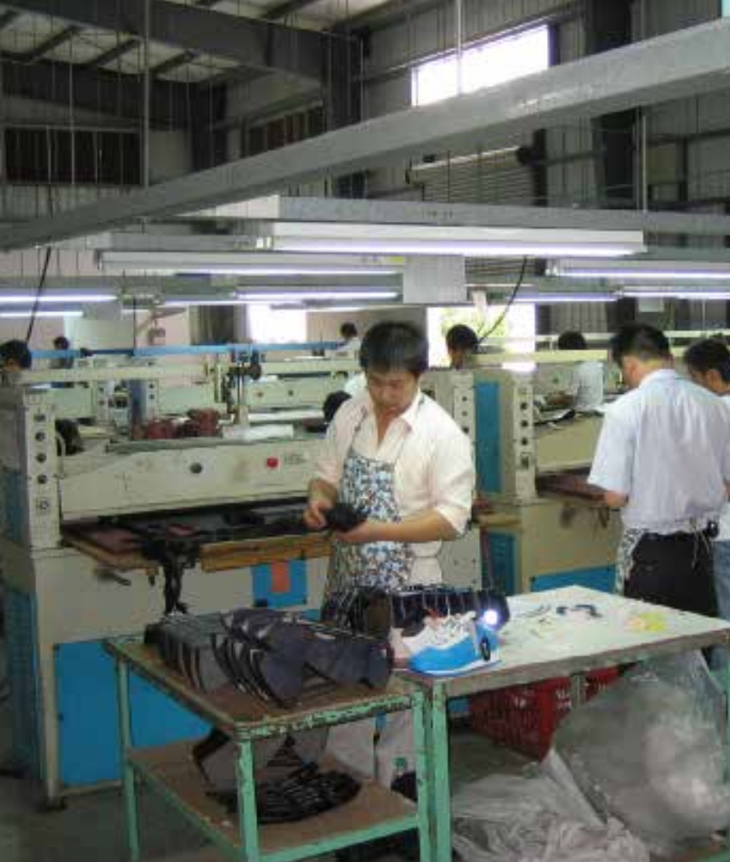
这是一个标准的裁断部门。裁切工具被工人配双，放成整齐的堆叠并分类部件。
