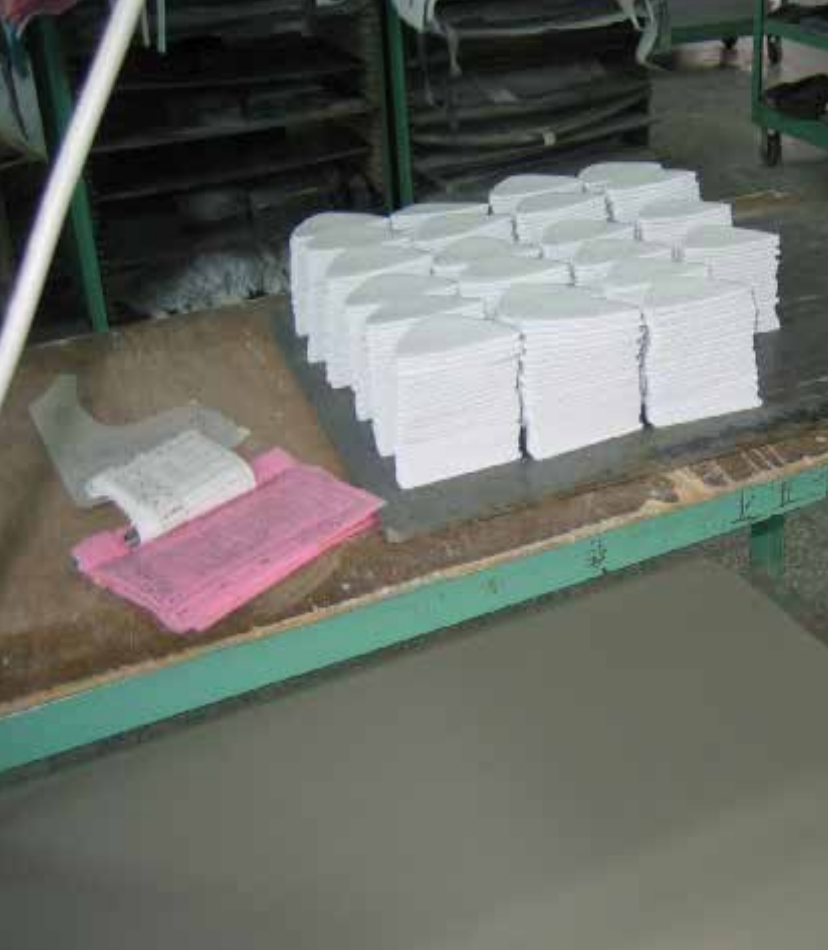
在这里，脚头片被裁切和堆叠，等待组装。 原料橡胶只能在几天内再循环使用。
