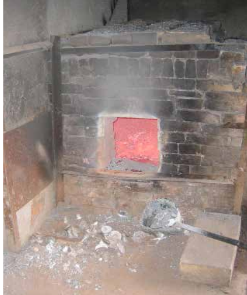
炽热的熔态铝用长柄桶铲出。 用完后要注意准备将它放回原位。
