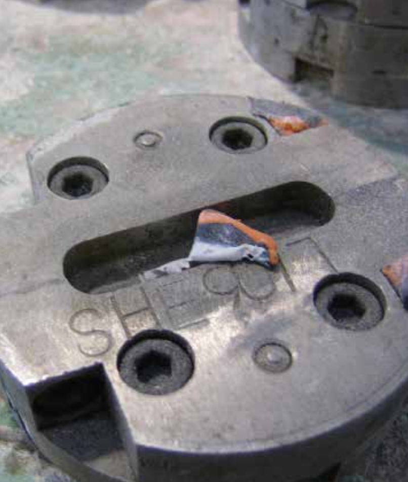
这是挤压头。这个螺栓在磨机上形成不同的条带图案。这个有3种颜色。
