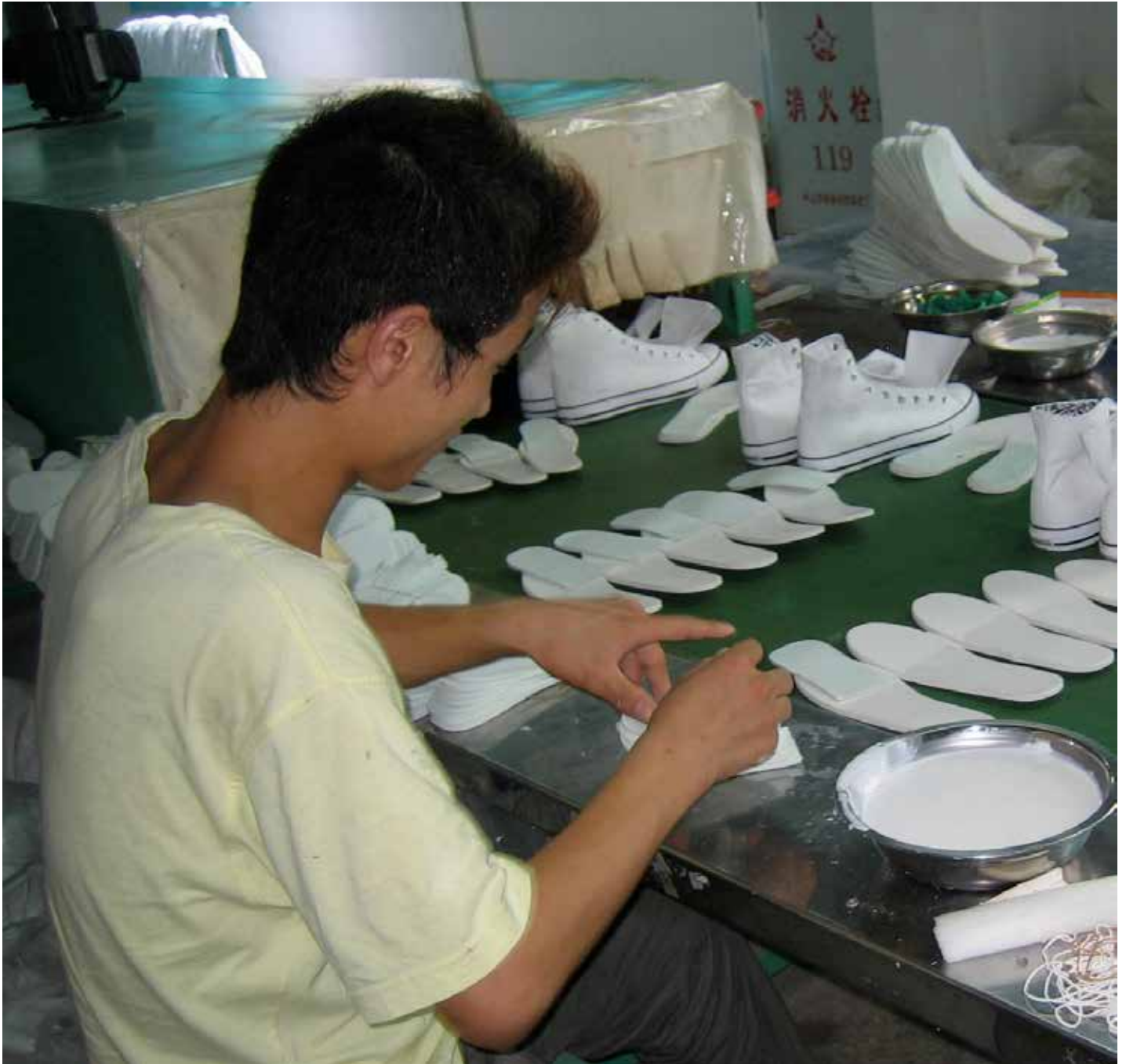
当橡胶固化时，鞋子从烤箱中取出。鞋子已准备好鞋带和鞋垫。在这里，工人将一个小的乳胶泡沫楔子粘在鞋床的底部。
