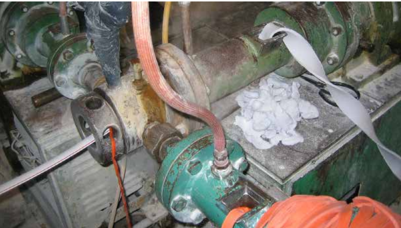
在这里，橙色橡胶被送入挤压机制造色带。
