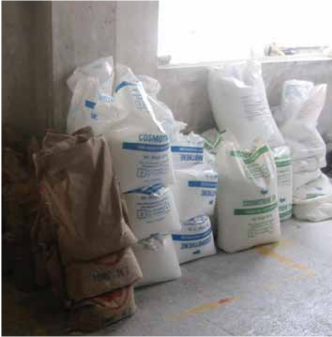
干燥原料是从日本、韩国、美国和德国进口的。复合配方包括塑料树脂 着色剂 和发泡剂。发泡剂是在加热时在塑料材料中产生微小气泡的化学组合。
