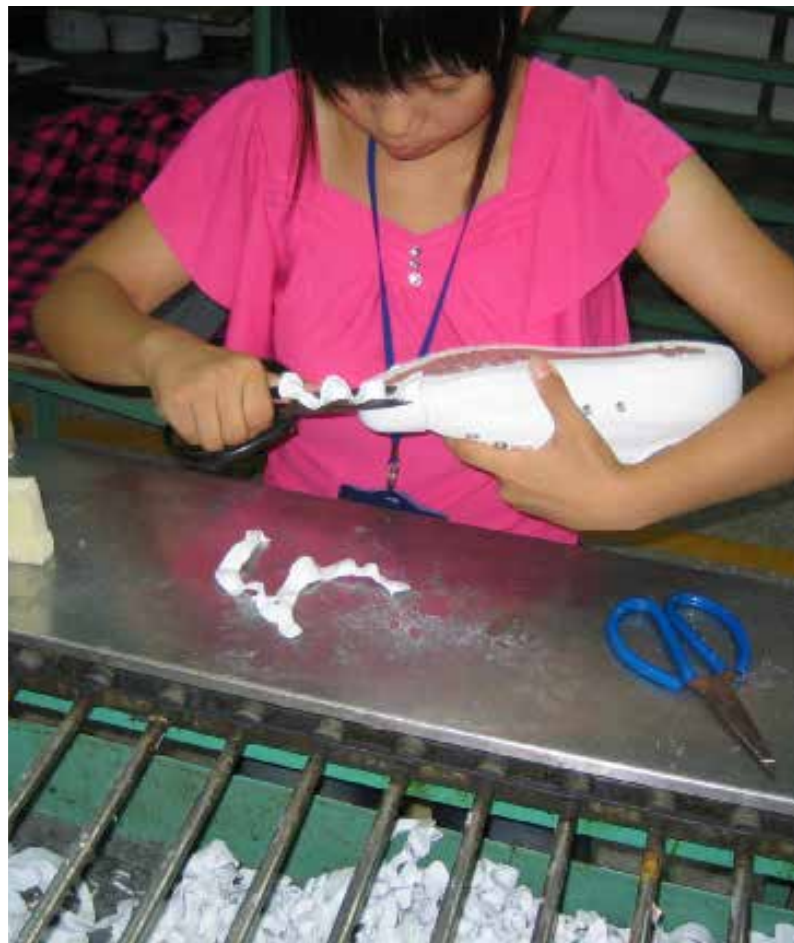
将多余的部份被修剪掉，剪下来的橡胶将被回收。
