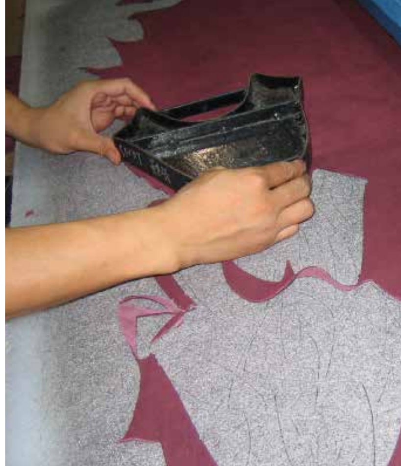
放在材料下面的是塑料切割垫。这使材料边缘保持整洁，但必须定期更换。裁切工人小心地将斩刀放置在皮料上。这些部件紧密地连接在一起，以减少“裁切损耗”
