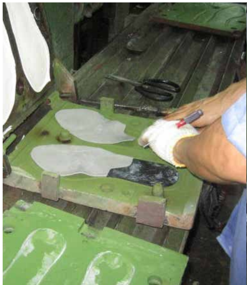
现在底部脚踏面橡胶被添加在后跟标志的顶部。
