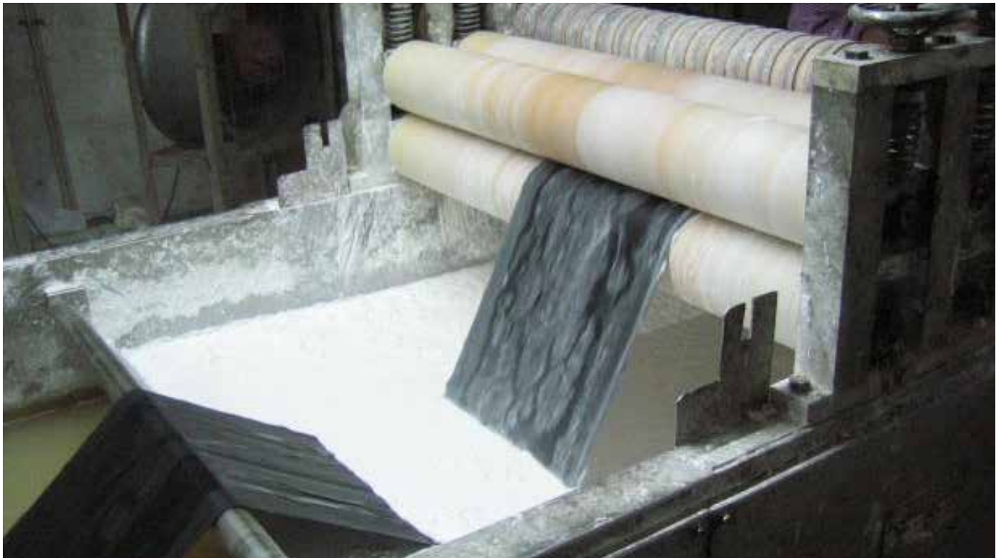
将它离抽离水放入一个电力浴，防阻橡胶粘到自己身上。工人把橡胶装入储存架上。
