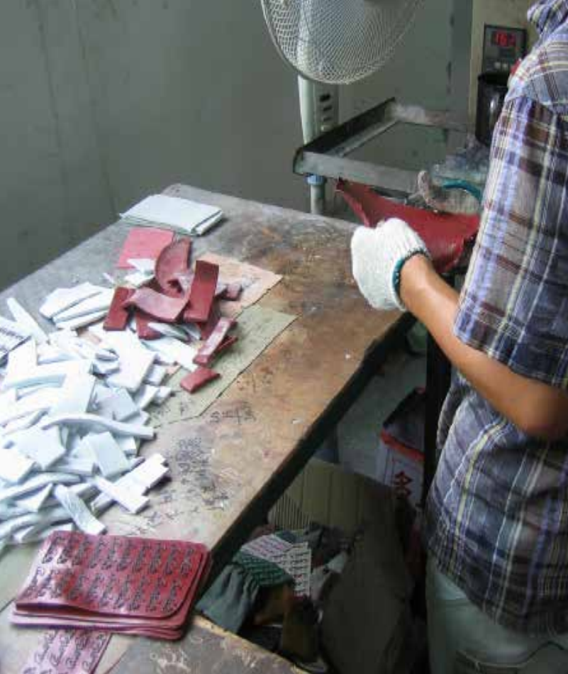
这里的工人正在修剪原料橡胶做后跟商标或“车牌”。
