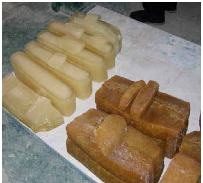
測量未固化的合成橡胶和天然橡胶，准备混合。
