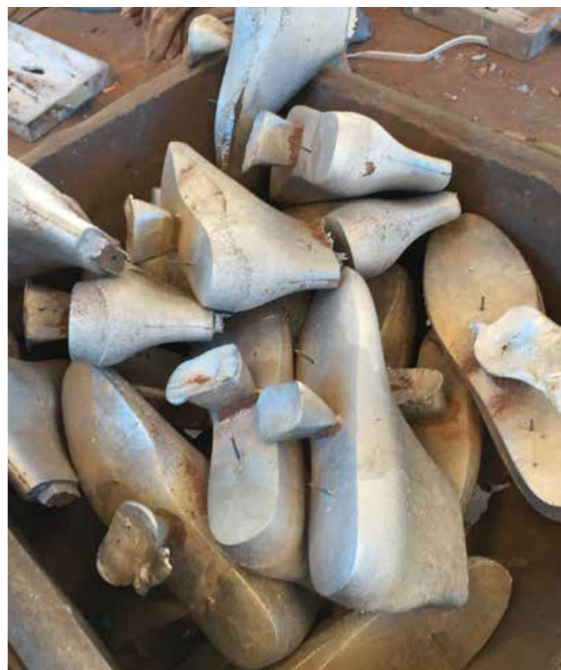
浇注几分钟后，模具就可以翻转，底部裂开。 鞋楦被移除，沙子摇晃了出来。 下一步，模压浇口将被切断 然后将楦头抛光。
