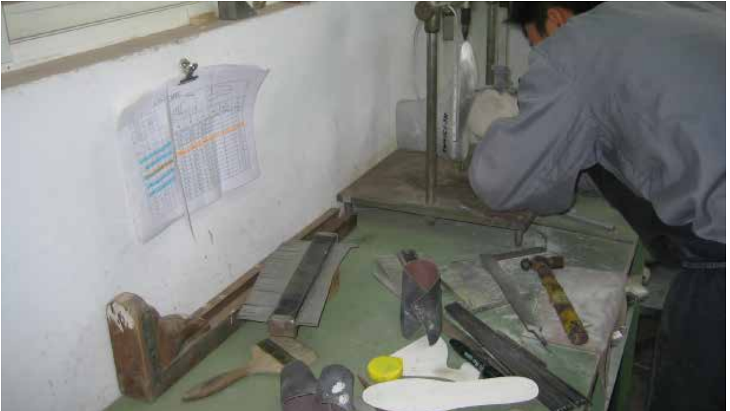
技师正在检查长度、底部外形、鞋头和后跟弧度。墙上挂的是楦头的级放规格。你也可以看到用来检查外观的针距。
