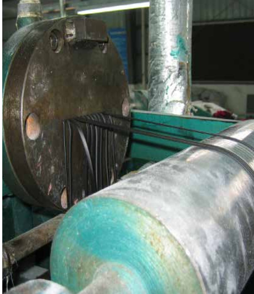
黑色条带用牵引辊被挤压和拉扯。
