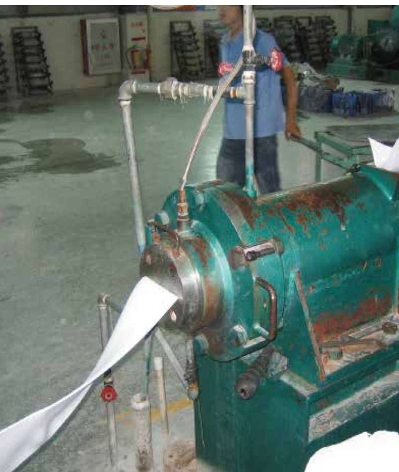
未硫化的橡胶被送入挤压机制造厚条。
