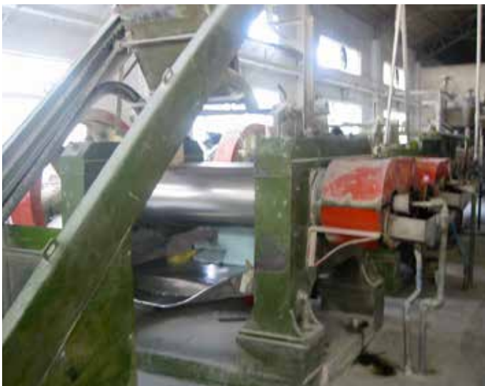
在混合机中，生料EVA被碾成如薄薄的“日历”表，就像橡胶化合物。
