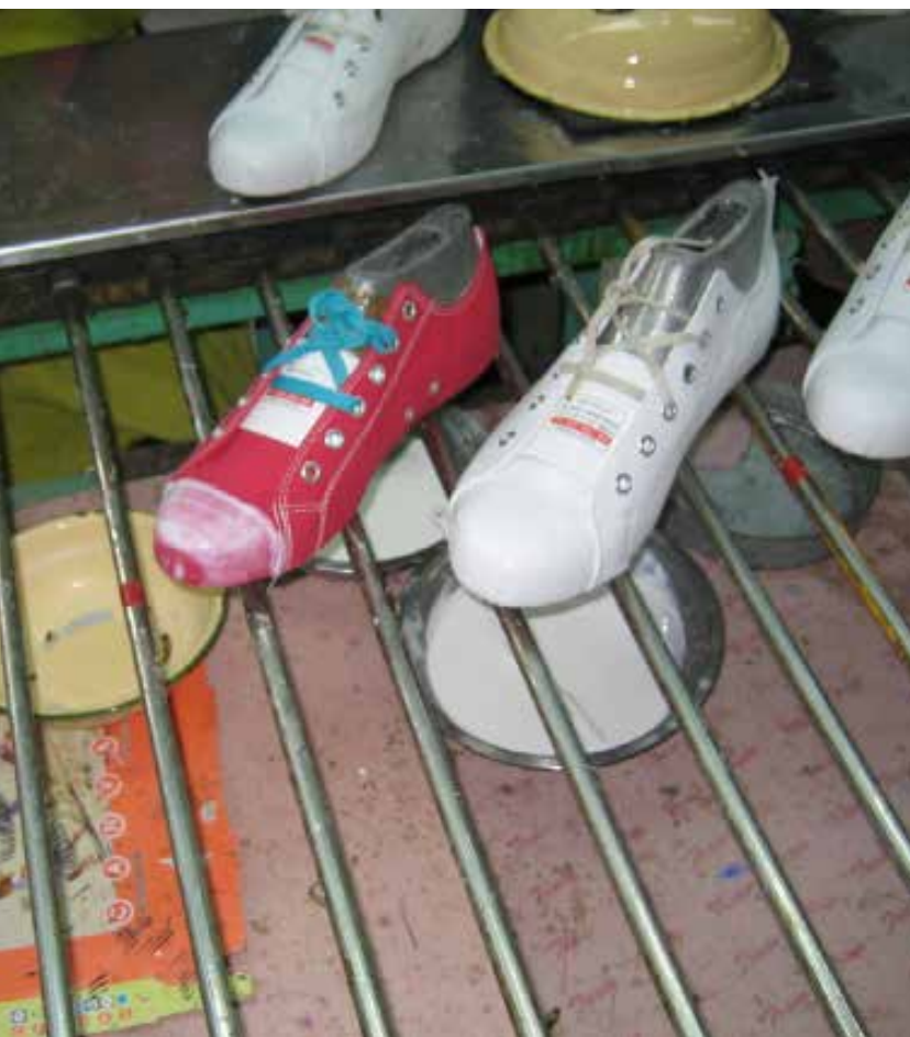
在橡胶加工之前，鞋头片被胶合。橡胶薄片在涂胶后拉紧。
