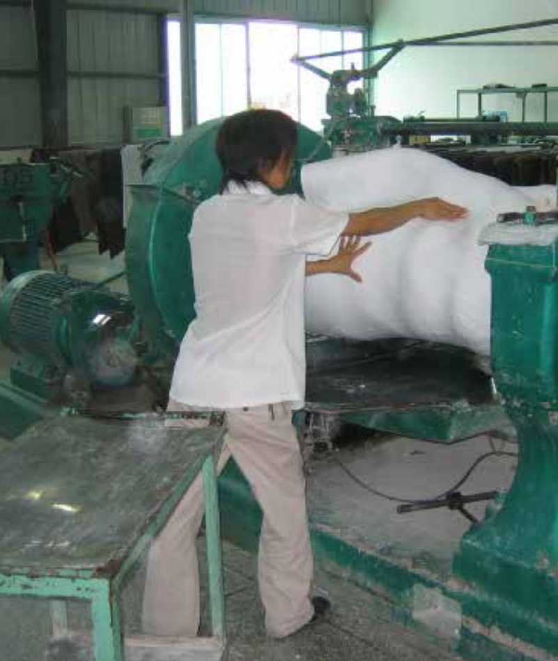
未硫化的橡胶装入磨机进行混合。
