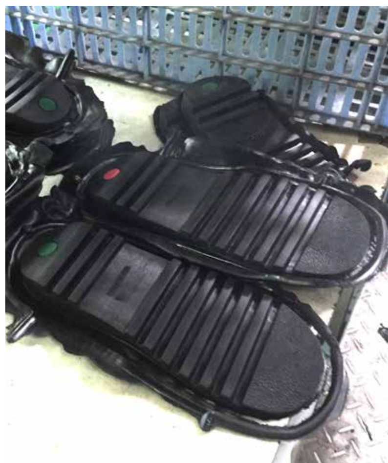
这种橡胶现在冷却到可以处理了。 额外的橡胶从边缘灰化确保模具完全充满橡胶， 接下来将准备修剪了。
