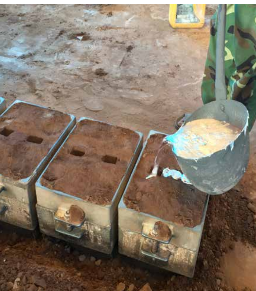
将金属倒入砂模中。
